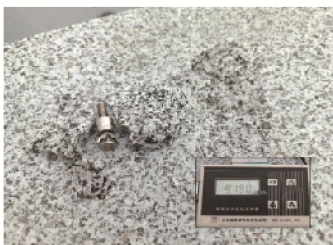
正常种植拉拔9.19KN
